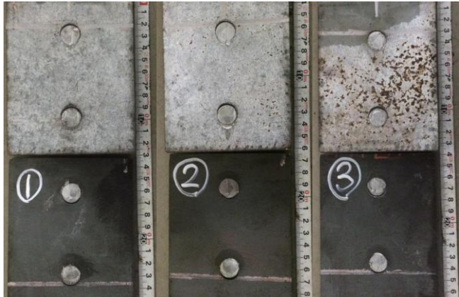
写真2 破断後の2本 TRS 試験体
