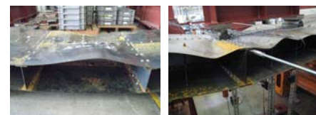
g) 3.2mm パネル h) 1.6mm パネル 写真2 リブ及び薄板パネル座屈状況
