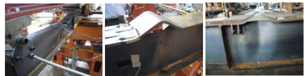
写真1 試験体A1~A3 座屈状況
