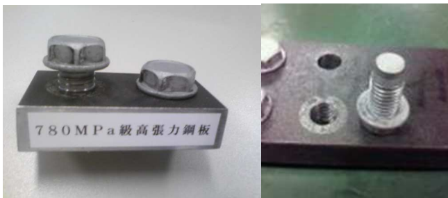
写真.3 高張力鋼への締結
