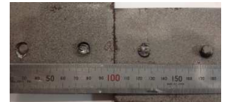
写真-2 V2-05 ねじ破断
