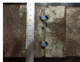
写真-3 V2-04 鋼板破断
