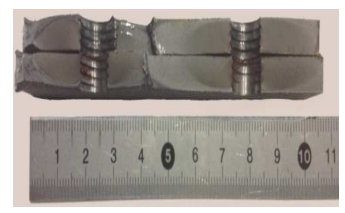
写真-3 V2-04 鋼板破断
