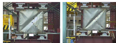
写真 1 試験体破壊状況
