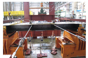
写真1 横座屈防止用鉄筋
