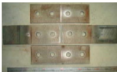
写真 - 1 解体後の試験体
