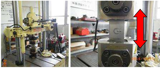
写真.2 疲労試験機および試験状況
